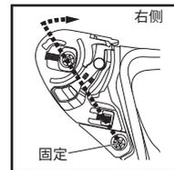
调整镜片后，请参照“硅油的使用方法”，在视窗橡胶圈上涂抹硅油。
