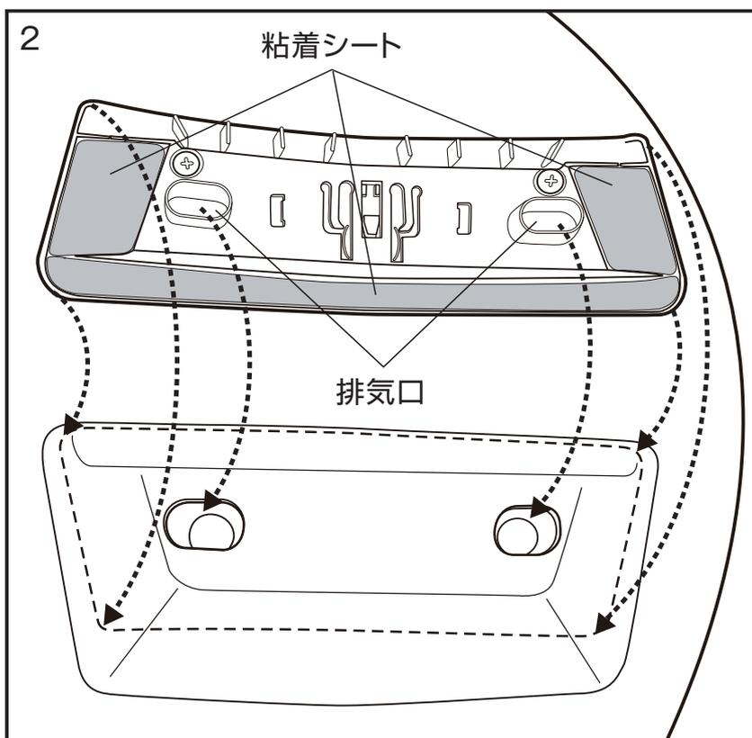
取り付けは、新しいNEOTECTトップエア アウトレットの裏面の粘着シート(図2参照)の保護フィルムを取り、NEOTECTトップエア アウトレットの排気口と帽体の穴と合わせ貼り付けます。取り付け後は、粘着シート部分を上からよく圧着してください。
