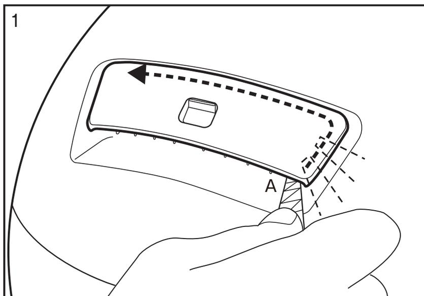
取りはずしは図1のAの位置より布を巻きつけたマイナスドライバーなどを差し込み、シェルをキズつけないように裏の粘着シートを形状に添って(図1の点線部分)はがします。取った部分のシェルは粘着シート、ゴミ、ホコリを取り脱脂し、きれいな状態にしてください。
